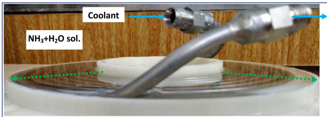
Foto 2. Vista do absorvedor compacto por filme inundante (SISEA LAB)
