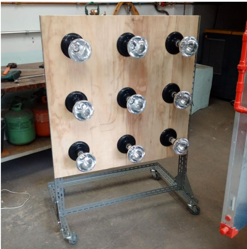
Figura 2 Painel de lâmpadas que possibilitam fluxo de energia radiante com gradação de intensidade de fluxo radiante. (SISEA)
