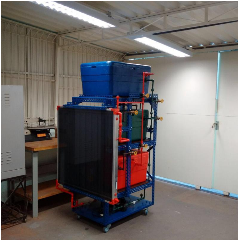
Figura 1 Bancada de laboratório e esquema de circulação de fluido para ensino de conversão térmica de energia solar. (SISEA)
