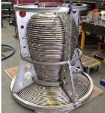
Figura 1 – (a) Receptor solar de cavidade desenvolvido pela ANU; (b) Receptor instalado no topo da torre
